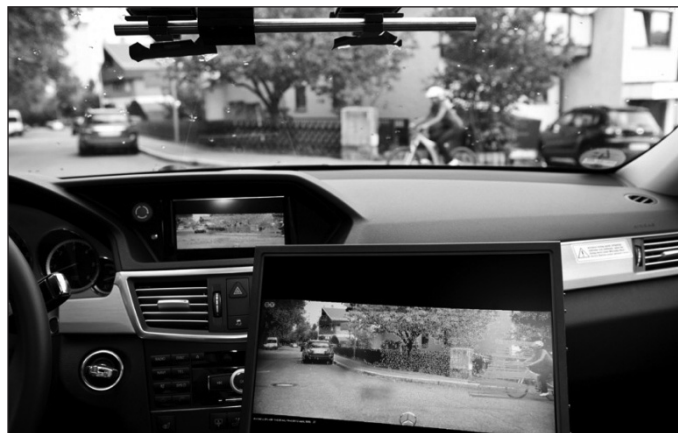
Ismeretes, hogy 50 km/h sebességen a gépkocsi megállási úthossza 15 m. A 6D-s jármű számítógépe kétszer gyorsabb a vezetőnél, ezért 7 méter után automatikusan fékez, és ennél, egy teljes járműhosszal rövidebb úton megáll
