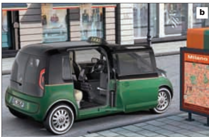
A hibrid VW e-Up alapokra épülő londoni (a) és milánói (b) taxi két utas szállítására, előre tolt C-oszloppal, utas oldali tolóajtóval készül
