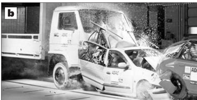
Az álló gépkocsikba rohanó tehergépkocsi túlélést kizáró roncsá gyűri az előtte, dugóban várakozó személyautókat (b)
