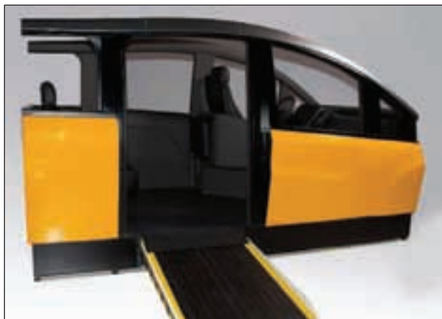
A kerekesszékes utasok a jármű mindkét oldalán kitolható rámpán gördülhetnek az utastérbe
