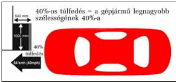
Az EURO NCAP frontális ütközésének vázlatja
