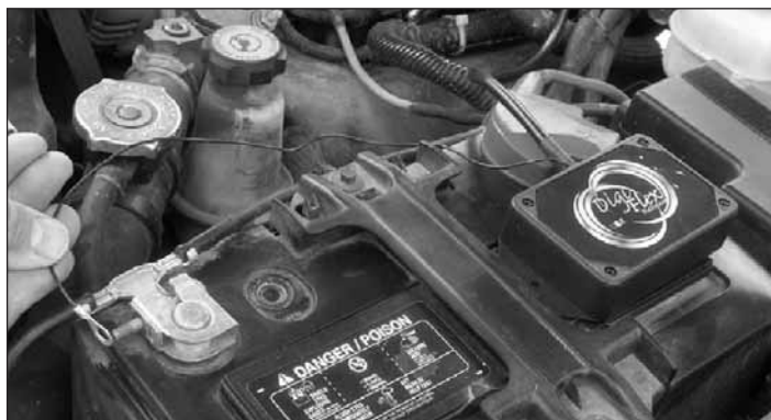
A E85-ös vezérlőegységek akkor működnek biztosan, ha közvetlenül az akkumulátorról kapnak tápfeszültséget
