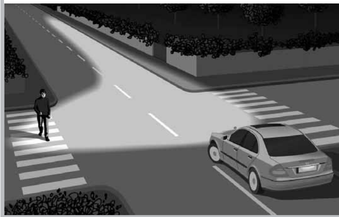
Intelligens Világítási Rendszer rendelhető az új típusokhoz. A képen jól látszik, hogy a kanyarodásnál a „beforduló” ködlámpa a gyalogátkelőhelyet is megvilágítja
