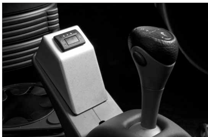
A választókapcsolót a középkonzolon helyezték el
