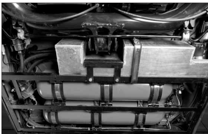
Jól elrejtették a két 16 literes földgáztartályt
