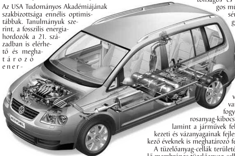
A Volkswagennek a frankfurti IAA-n bemutatott, Touran Eco Fuel elnevezésű, vegyesüzemű gépkocsija a jármű alján hordja földgáztartályait
