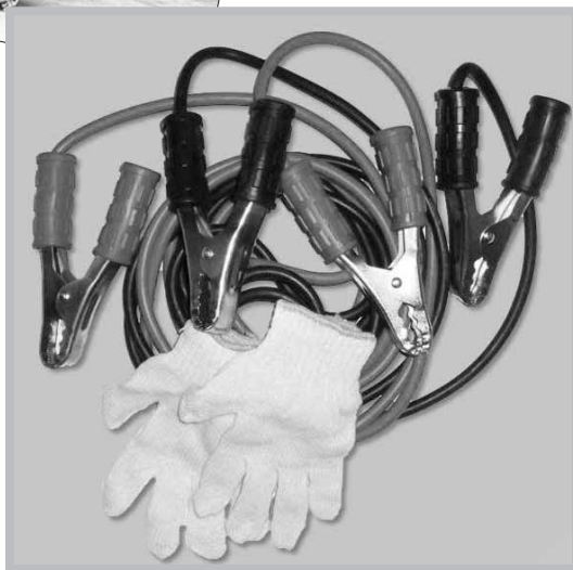
Az idegen akkuról végzett téli indítás tartozéka a szabványos indítókábel-pár
