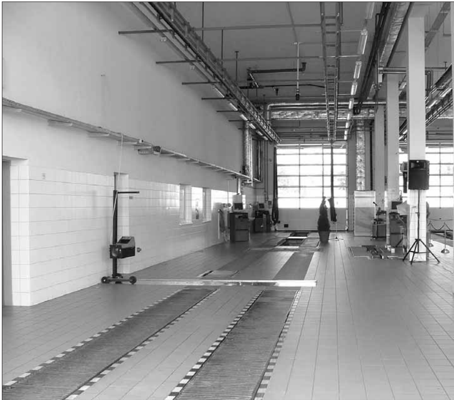
A vizsgasor mindent tud, ami egy személygépkocsi, teherautó vagy autóbusz vizsgáztatásához szükséges
