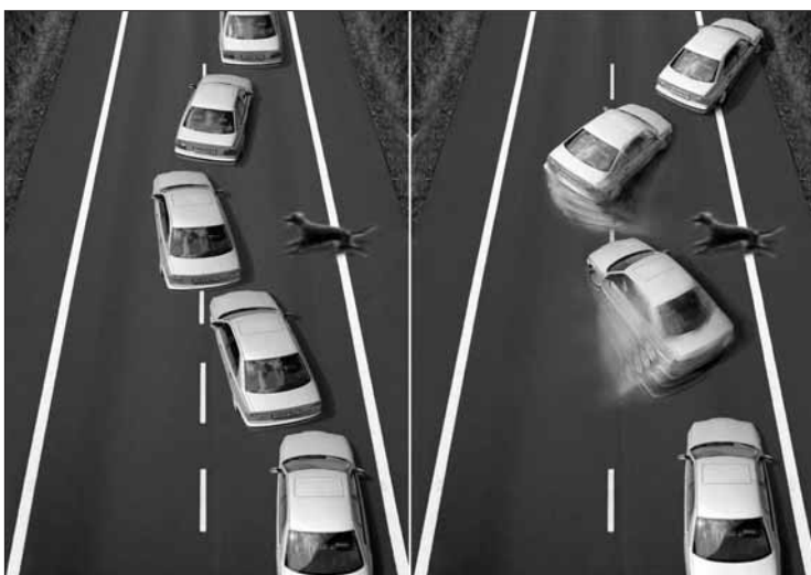
Az ESP-használat fázisai a jármű elé futó kutya kikerülése közben. Az iránystabilizáló fékbeavatkozásra a jobb oldali képrész életlen kontúrú járműfázisain kerül sor
