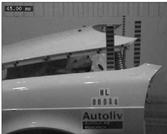
Az Autoliv aktív motorháztetője az ütközés érzékelésekor rugókra emeli a motorháztetőt
